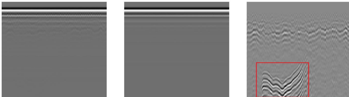
Рисунок 3 Пример выделения дефекта методом разности профилей. Первое изображение изначальный профиль. Второе изображение - модельный профиль. Третье изображение - результат.
