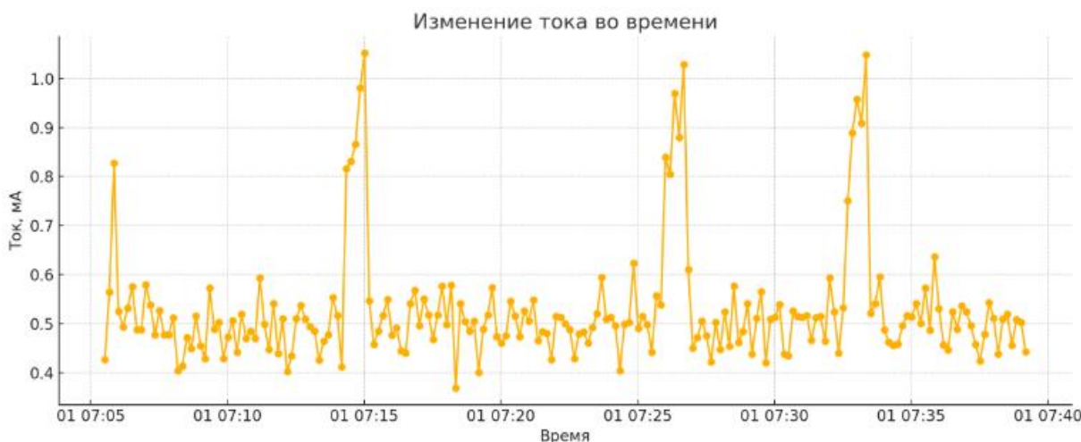
Рис 1. Оцифрованные показания замеров работы тестового устройства на включение и выключение. Основа для формирования цифровой сигнатуры.
