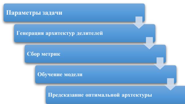
Рис. 1. Блок-схема процесса оптимизации архитектур делителей.
