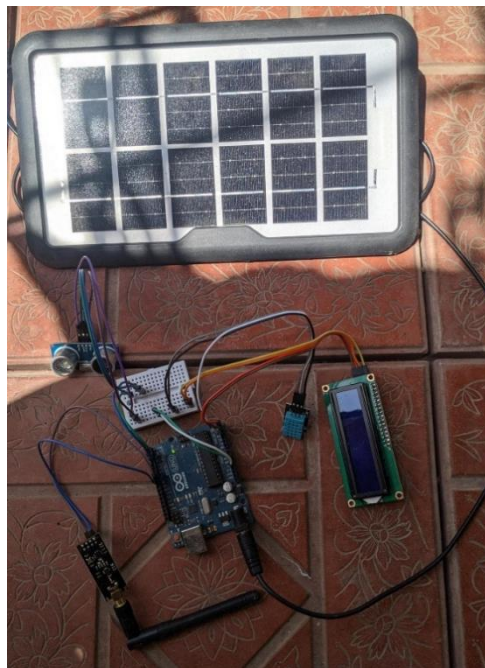
Рисунок 4: Автономная подсистема приема и передачи данных об уровне воды и температуре на солнечном питании
